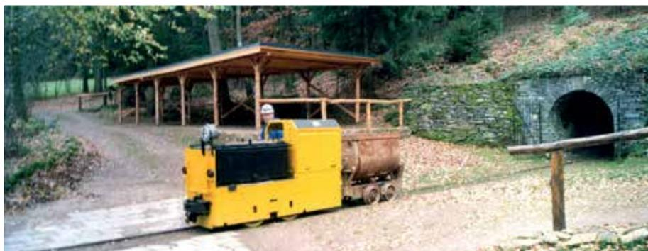
Die frisch rekonstruierte Grubenlok vor dem Mundloch des „Engländerstolln“ (o); Neue verzinkte Stahlfahrten mit Umsteigeübühne im Südostüberbau, Länge 20 m zur Kopfstrecke und dem ausbetonierten Schurfschacht 1, Länge 16 m über Betonröhre zum Tagschacht (re); Tagschacht mit betoniertem und verschlossenem Ausstieg in der Funktion als Wetterschacht und Notbergungsschacht (li). Fotos: Archiv der Kirchberger Natur- und Heimatfreunde
