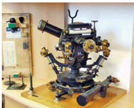
Größtes von Hildebrand hergestelltes Instrument, Universaltheodolit mit 21cm Grundkreis und zentrisch gebrochenen Fernrohr. Foto: Jörgen Schütze
