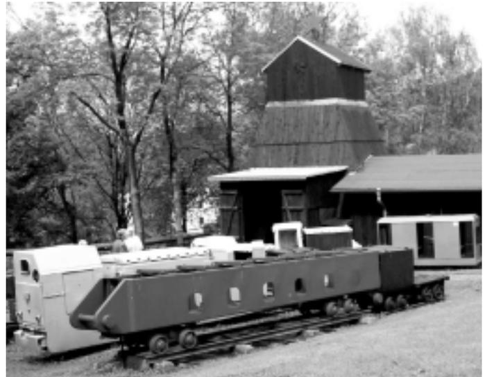
Ein Blick auf die ausgestellte Technik (im Vordergrund ein Gestellförderkorb zum Transport von Bohrgestängen dahinter Grubenloks). Foto: Berndt Fischer
