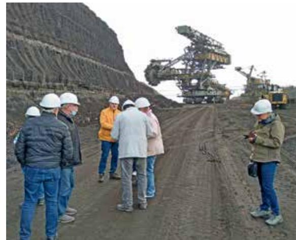
Schaufelradbagger 1530 SRs 1301 im Kohleflöz des Tagebaus Welzow-Süd
