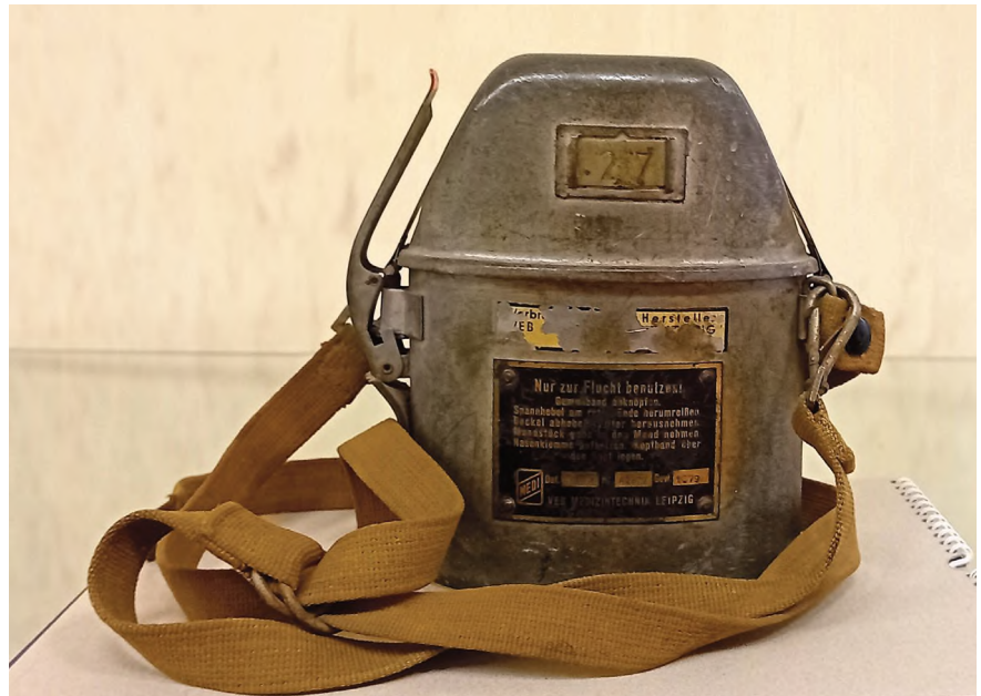
Filter selbstretter, hier Produktionsjahr 1956, erhielt jeder Bergmann der SDAG Wismut. Das ist der persönliche Selbstretter von Lothar Wetzen welcher selbst viele Jahre Mitglied der Schneeberger Bergbrüderschaft war! (Fotos: Sammlung Hermann Meinel)
